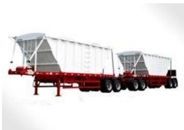
Figura 05 – Veículo autodescarregável do tipo Hopper (PASTRE, 2013).
