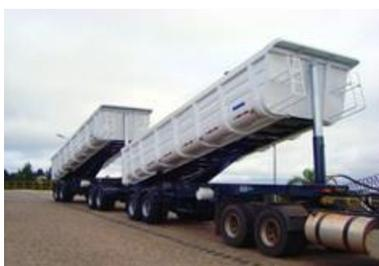
Figura 06 – Veículo autodescarregável do tipo Basculante (PASTRE, 2013).
