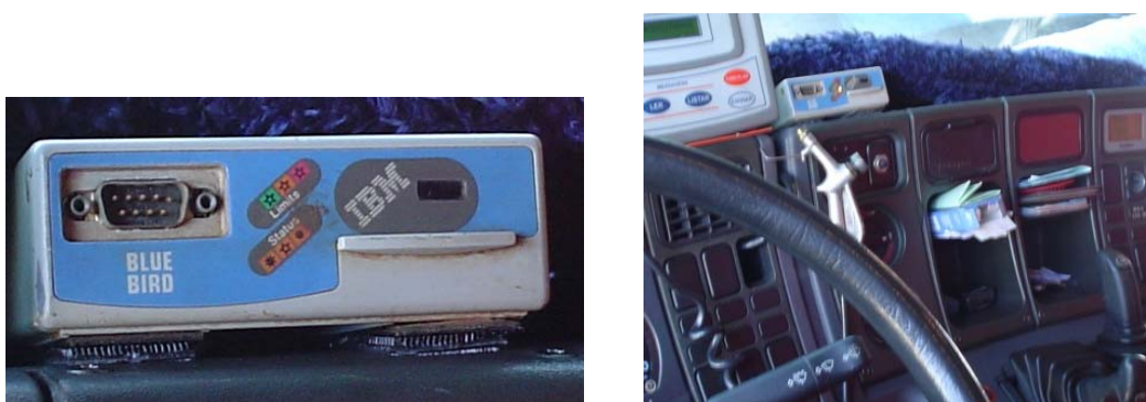
Figura 22 – Vista frontal do computador de bordo utilizado para a coleta de dados, já instalado no caminhão
