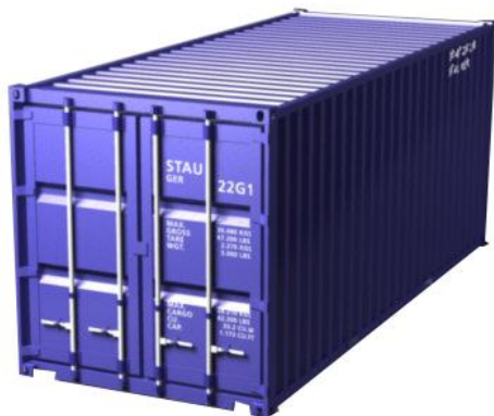
Figura 1 - Dry Box, exemplo de container de carga geral.
