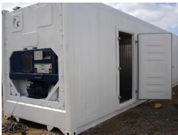
Figura 2 - Container refrigerado, exemplo de containers térmicos.
