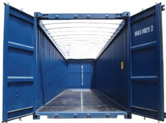
Figura 6 - Container Open-Top. (disponível em: http://www.portogente.com.br/arquivos/id_24571_containeropentop.jpg )
