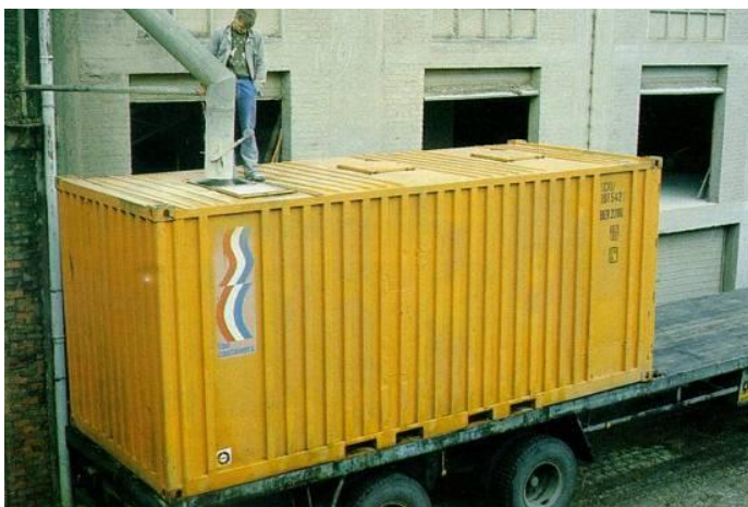
Figura 4 - Container Granel sendo carregado. (disponível em: http://www.novomilenio.inf.br/porto/pfotos/seacon64.jpg )
