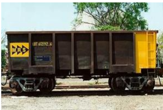
Figura 12: Vagão graneleiro com capacidade de Transportar 58-60 toneladas.
