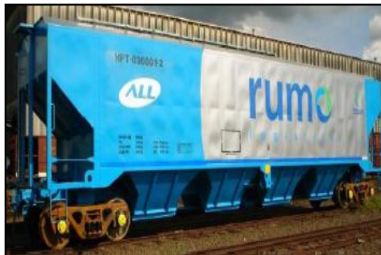
Figura 13: Vagão graneleiro com capacidade de Transportar 85-90 Toneladas.
